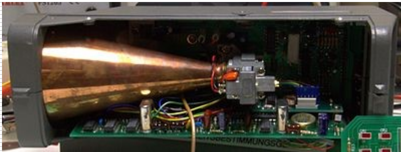
Radarowy miernik szybkości z diodą Gunna
