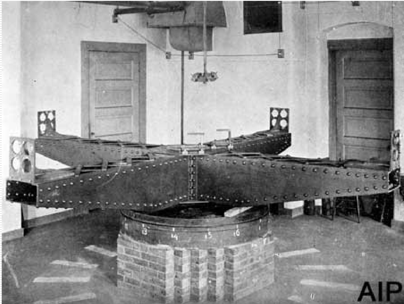
Fotografia interferometru Michelsona-Morley'a (1905r.) Mt.Wilson CA
