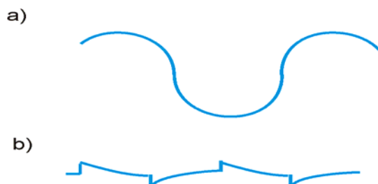
Rys. 1.7 a) Efekt sprzężenia pojemnościowego pomiędzy badaną linią sygnałową a źródłem przebiegu prostokątnego; b) Efekt sprzężenia pojemnościowego powstałego na skutek braku połączenia w obrębie sondy oscyloskopowej
