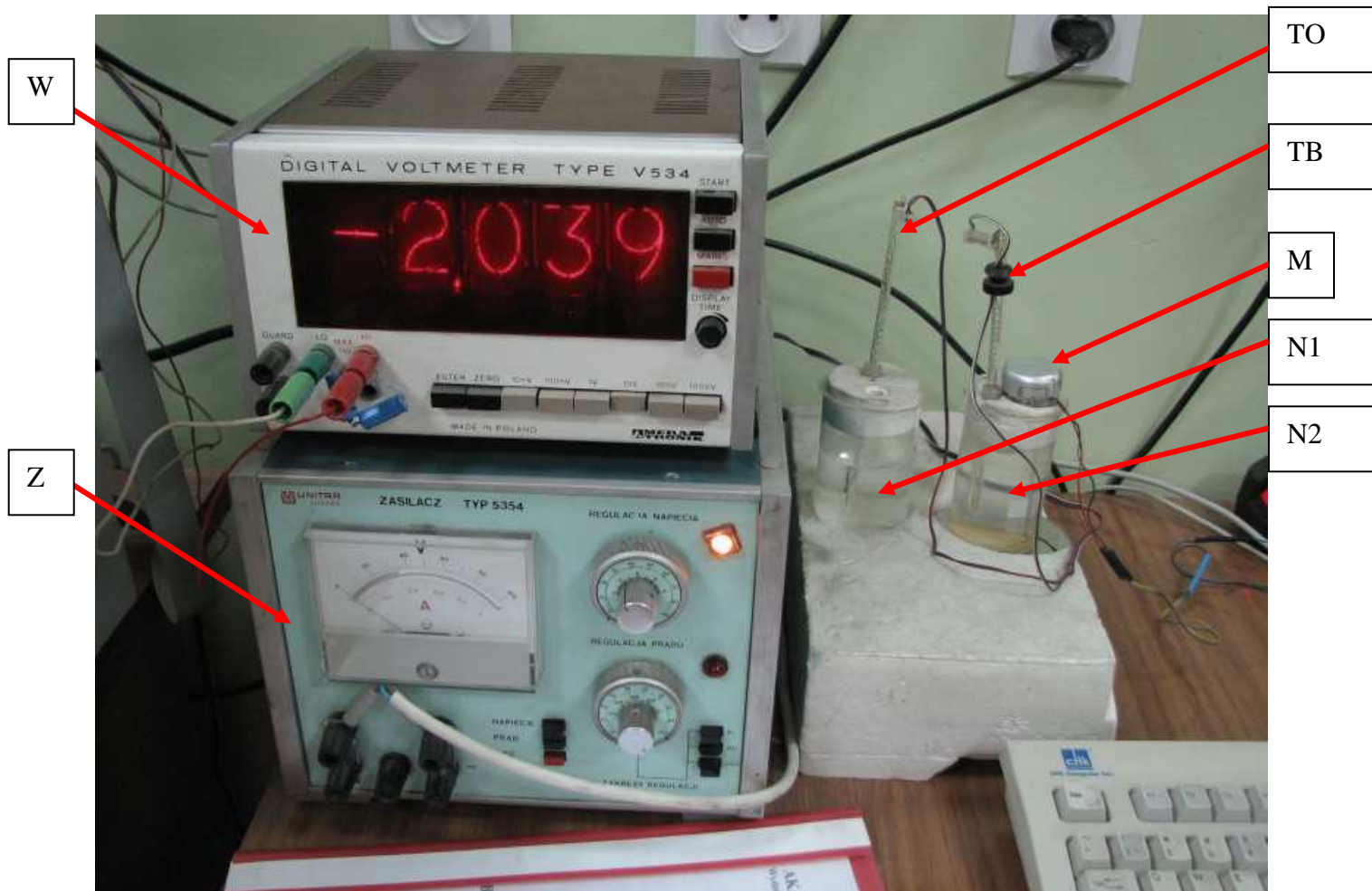
Rys. 2. Przyrządy wykorzystywane w ćwiczeniu. Oznaczenia: W – woltomierz, Z – zasilacz podgrzewanego stolika, P1 – pojemnik z wodą w temperaturze odniesienia T_1 (pokojowej), P2 – pojemnik z wodą o temperaturze podwyższonej T_2 , TO – termopara odniesienia, TB – badana termopara miedź-konstantan, M – mieszadło
