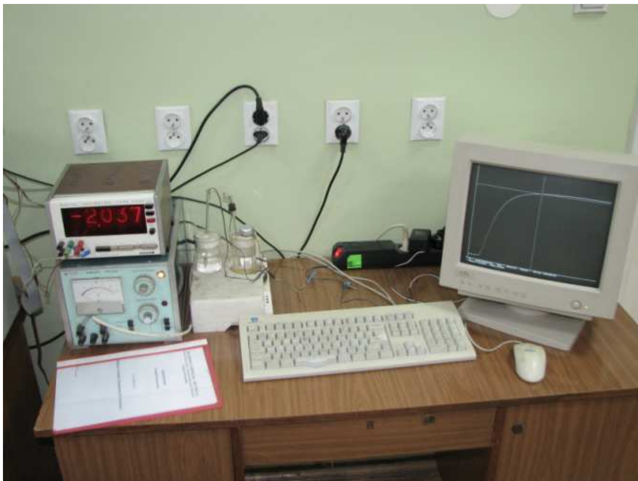
Rys. 1. Wygląd stanowiska wykorzystywanego do badania własności dynamicznych termopary
