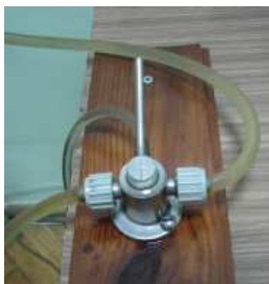
Rys. 3. Zawór sterujący przepływem cieczy dielektrycznej
