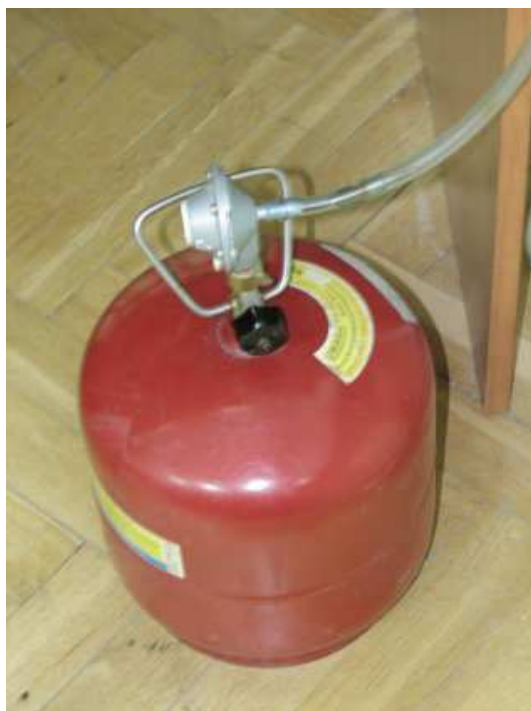
Rys. 3 Butla z gazem używana podczas badania czujników gazów – widoczny zawór odcinający gaz oraz reduktor ciśnienia gazu
