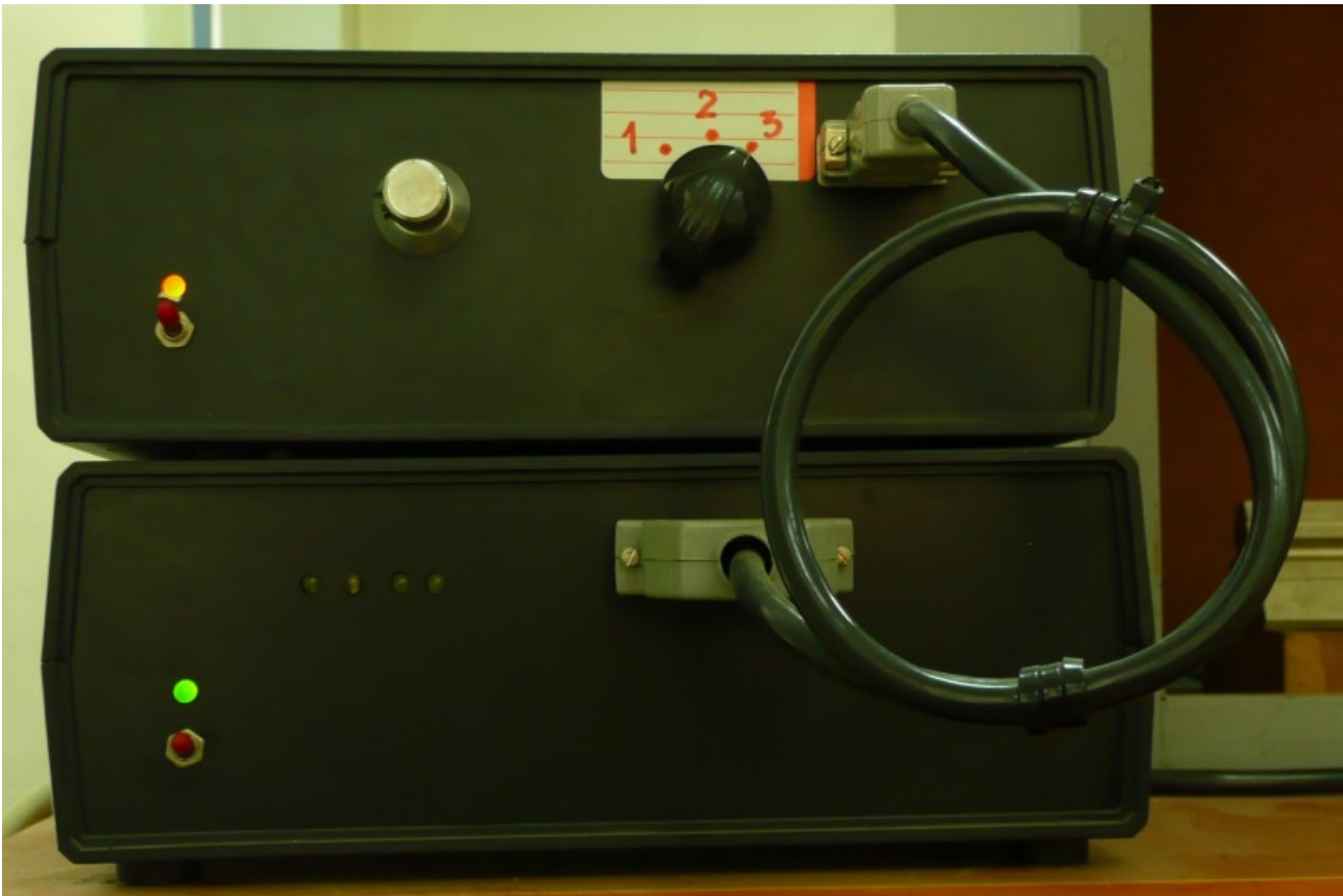
Rys.6 Układ polaryzacji i pomiaru prądu detektora – panel górny i sterownik silnika krokowego - panel dolny.
