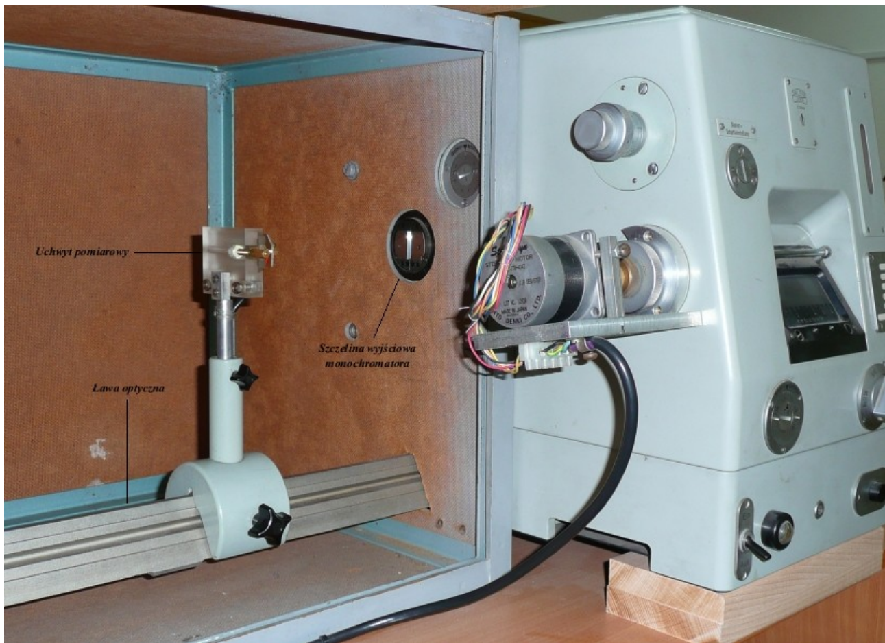
Rys.3 Wnętrze komory pomiarowej z uchwytem badanych fotodetektorów.
