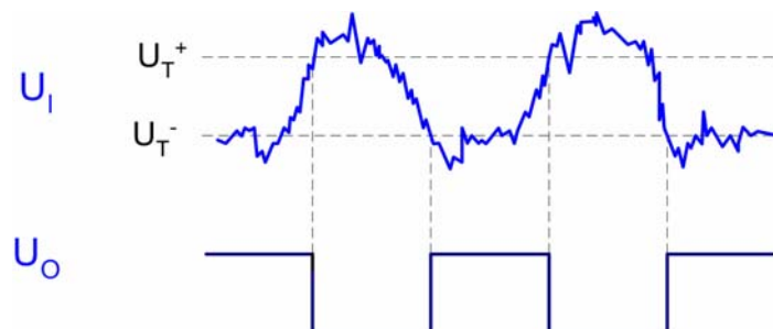
Rys. 4.16 Zakłócenia na wejściu bramki z układem Schmitta oraz sygnał na jej wyjściu (jedno z wejść bramki podłączono do napięcia zasilania)
